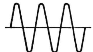
Seitenband-Signal (Oszillographeinstellung 1 msec)
