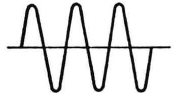
Seitenband-Signal (Oszillographeinstellung 1 msec)
