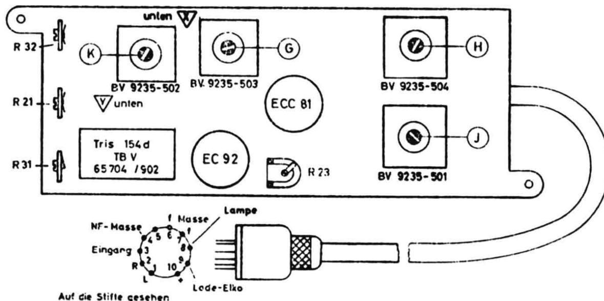
Der Abgleich erfolgt zweckmäßigerweise zusammen mit dem Rundfunkgerät. Das Gerät ist dabei exakt abzustimmen, die Scharfabstimmung, soweit vorhanden, einzuschalten und die Stereotaste zu drücken.
