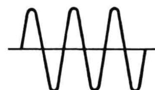
Seitenband-Signal (Oszillographeinstellung 1 msec)
