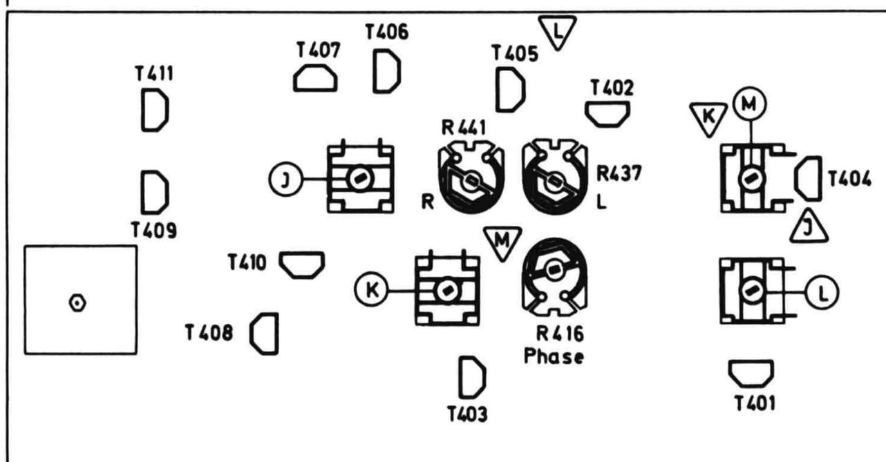
Der Abgleich erfolgt über HF zusammen mit dem Empfänger. Das Gerät ist in Stellung "Stereo" abzustimmen und die Scharfabstimmung einzuschalten. Der Abgleich sämtlicher Kerne ist außen.
