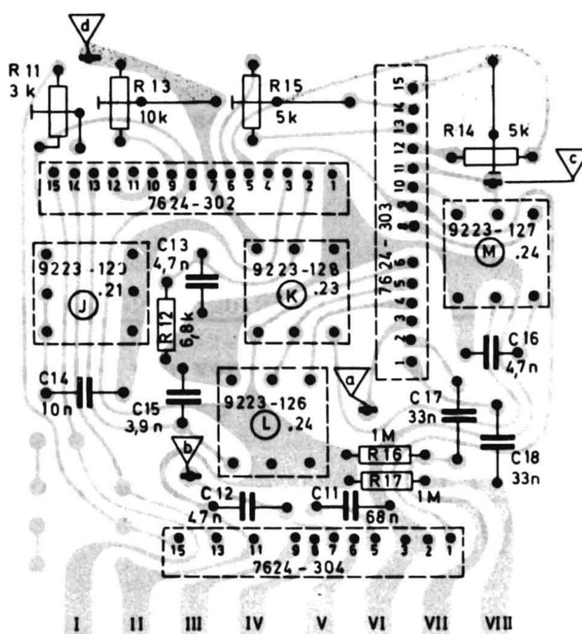
Die Reparaturanleitung stellt den Signalverlauf mit Spannungsangaben dar. Dabei sind die angegebenen Kontaktpunkte mit einem Oszillographen mit Tastkopf nach dem unten angeführten Schema abzugreifen. Es ist dadurch leicht festzustellen, ob der Fehler in einem der 3 Module oder außerhalb liegt.
