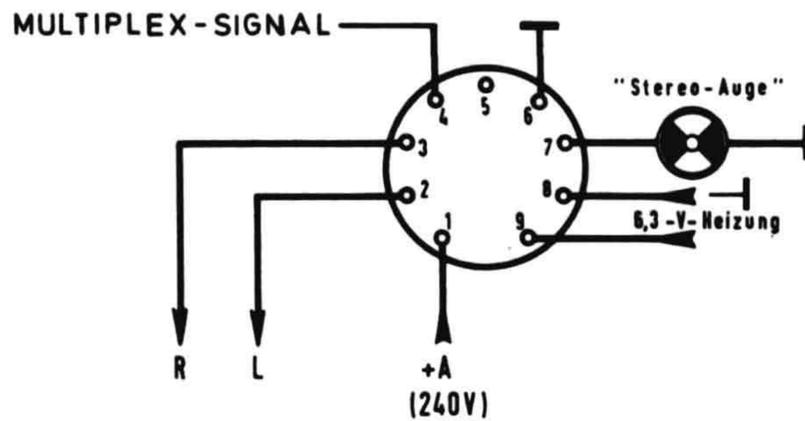
Coderausgang direkt an Decodereingang (Anschluß 4).
