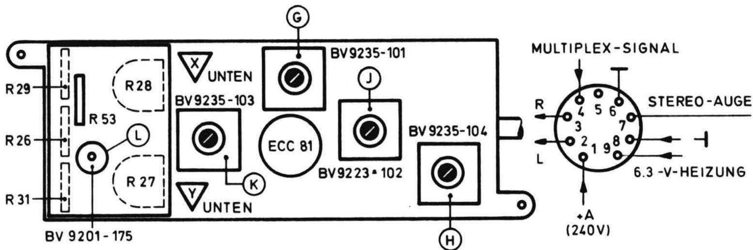
Der Abgleich erfolgt über HF zusammen mit dem Empfänger. Das Gerät ist in Stellung "Stereo" abzustimmen und die Scharfabstimmung einzuschalten.
