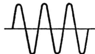
Seitenband-Signal (Oszillographeinstellung 1 msec)
