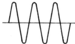
Seitenband-Signal (OszillographEinstellung 1 msec)
