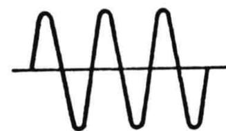
Seitenband-Signal (Oszillographeinstellung 1 msec)
