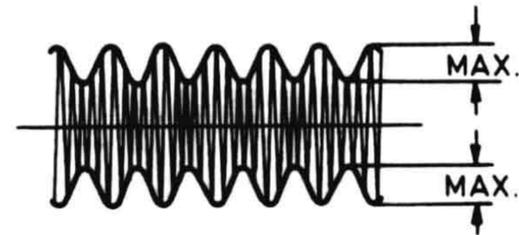
4) Abgleich des Resonanzkreises BV 9201-175 und des Empfindlichkeitsreglers R 53 der Mono-Stereo-Automatic
