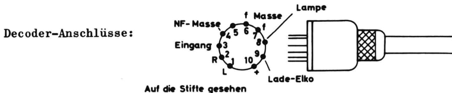
Coderausgang direkt an Decodereingang (Anschluß 3)
