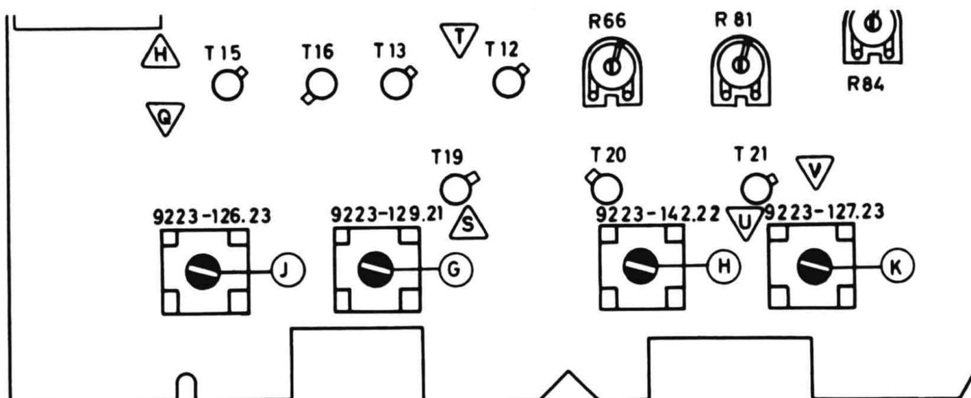
Der Abgleich erfolgt über HF zusammen mit dem Empfänger. Das Gerät ist in Stellung "Stereo" abzustimmen und die Scharfabstimmung einzuschalten.
